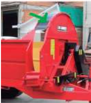
HOJA DESLIZANTE PARA AJUSTAR LA LONGITUD DE ESPARCIDO (PARA VIÑEDO/FRUTALES)
